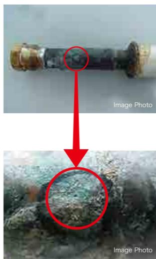
このことから漏水は、突然発生することが多いです。給湯管は専有部分(図参照)に敷設しており、漏水した場合、上階から下階に漏水が発生するため、上階の方が気づかないうちに、突然下階から連絡があり気づくことが大半で、対処が遅れば遅れるほど下階の被害が大きくなります。緊急対応として上階のメーターボックス内にあるお湯の水栓を締めなければ漏水を止めることはできません。(写真赤色丸部)
